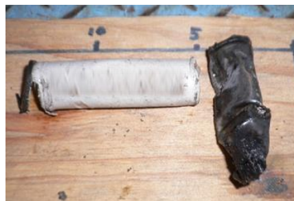
消火後のリチウムイオン電池
