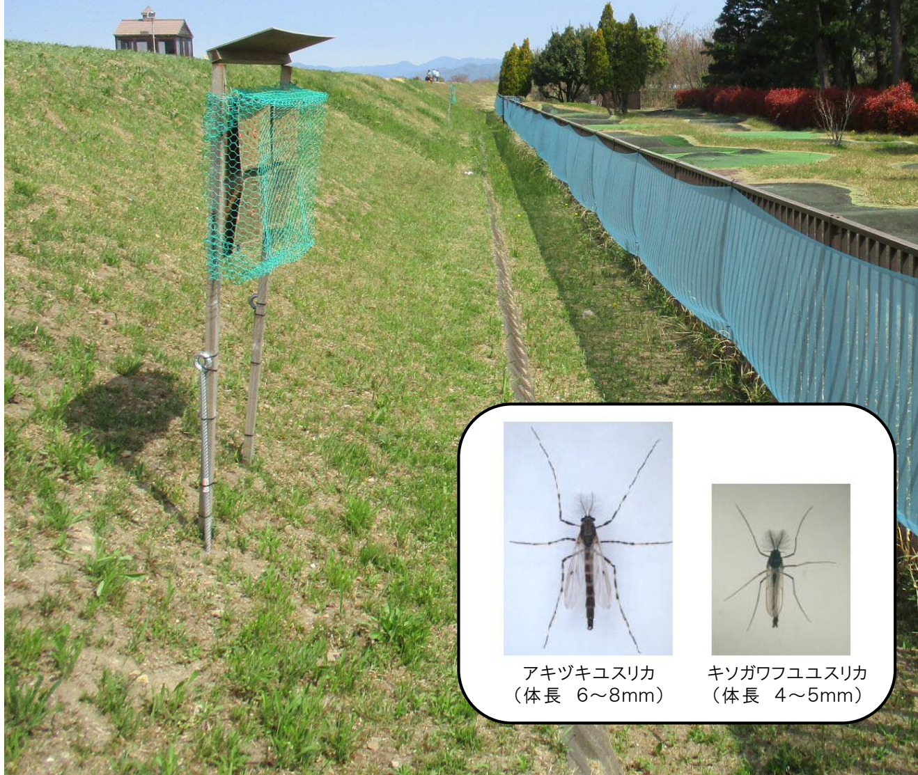
設置場所③に設置された粘着トラップ及び防虫ネット
