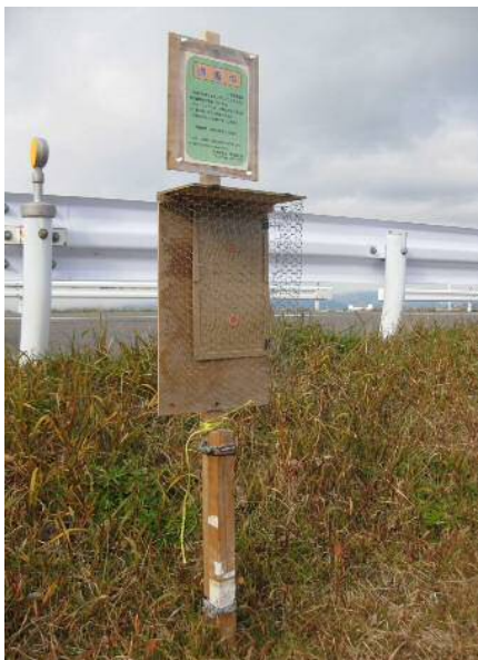
写真4 粘着トラップ板の設置状況
