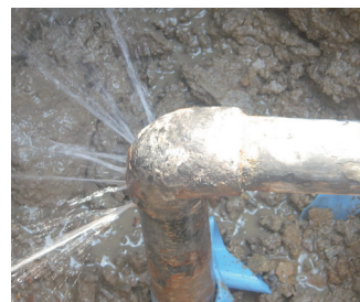
老朽管からの漏水
