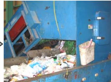
③ 2階のベルトコンベアーに落ちる
