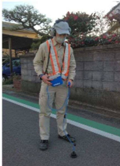
漏水探知器にて路面下の漏水音を確認
