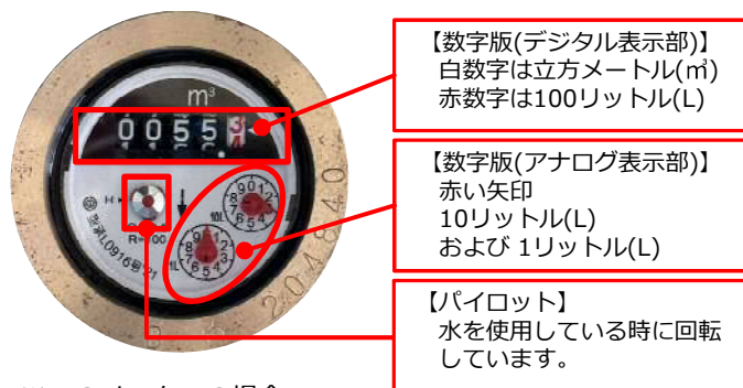
< 水道メーター >
