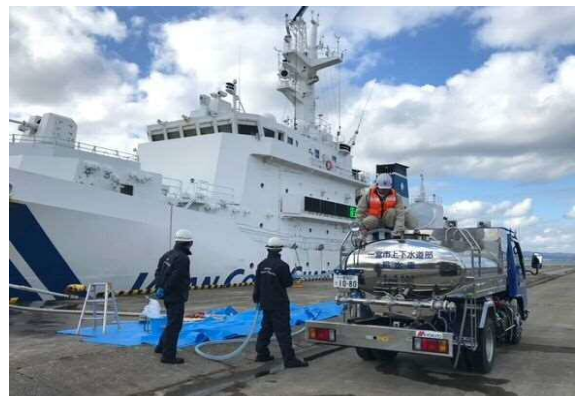
海上保安庁巡視船から給水車への補水作業状況
