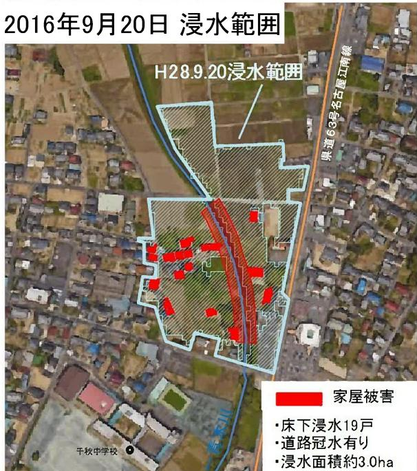
工事実施後の同規模降雨 (2016.9.20)による被害想定
