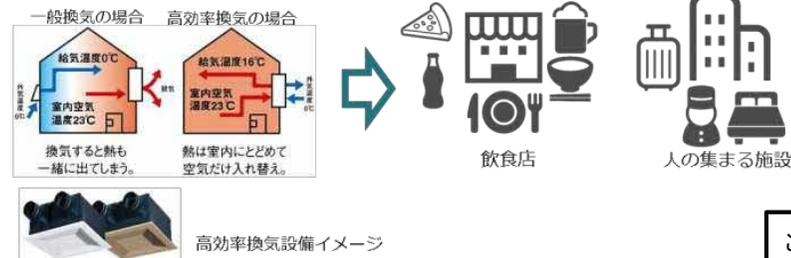
※高機能熱交換型換気設備：自然給気とファンによる排気の従来型換気システムに比べ、給気・排気ともにファンにより行うことで、確実な換気が可能、かつ熱交換により温度変化の抑制が可能。
