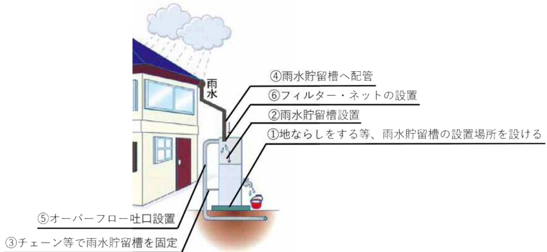
図 5.2.雨水貯留槽（地上型）設置方法
