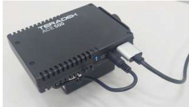
図表 10-8-8 実証実験機材 映像伝送装置（受信）
