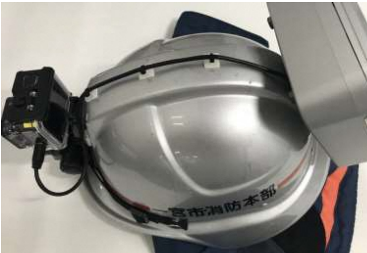
図表 10-8-6 実証実験機材 GoPro ヘルメット取り付け（配線経路）
