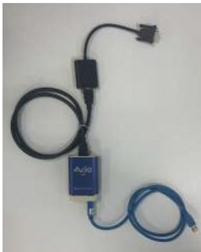
図表 10-6-2 実証実験機材 VGA-USB 変換
