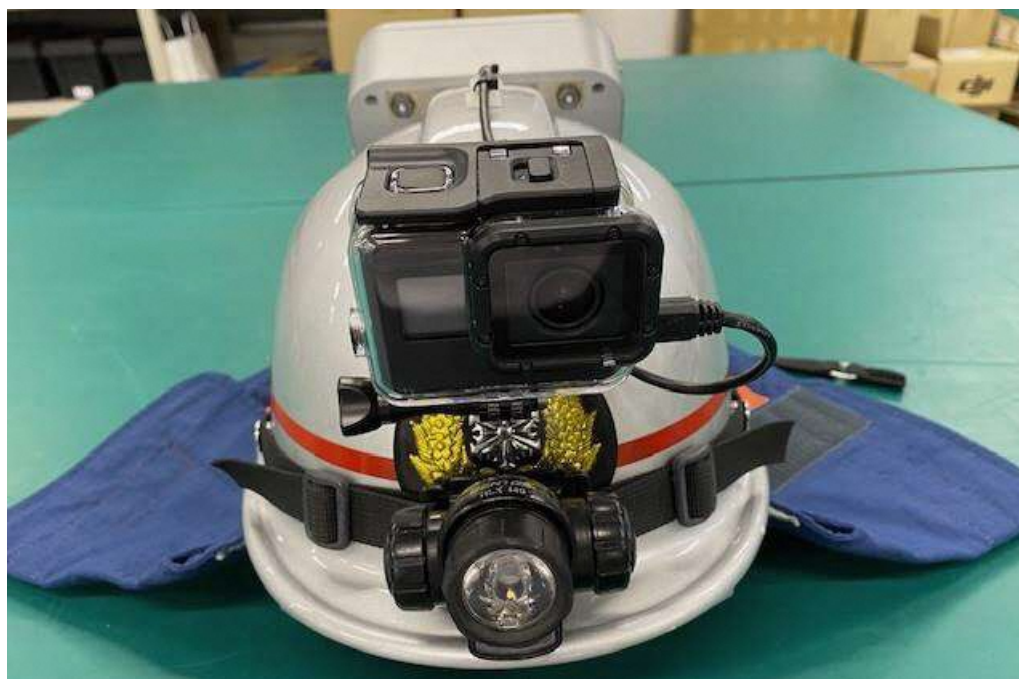
図表 10-8-3 実証実験機材 GoPro ヘルメット固定方法
