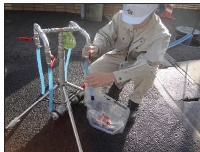
※応急給水栓による給水
