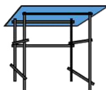
単管パイプ組による 屋根掛け小屋等
