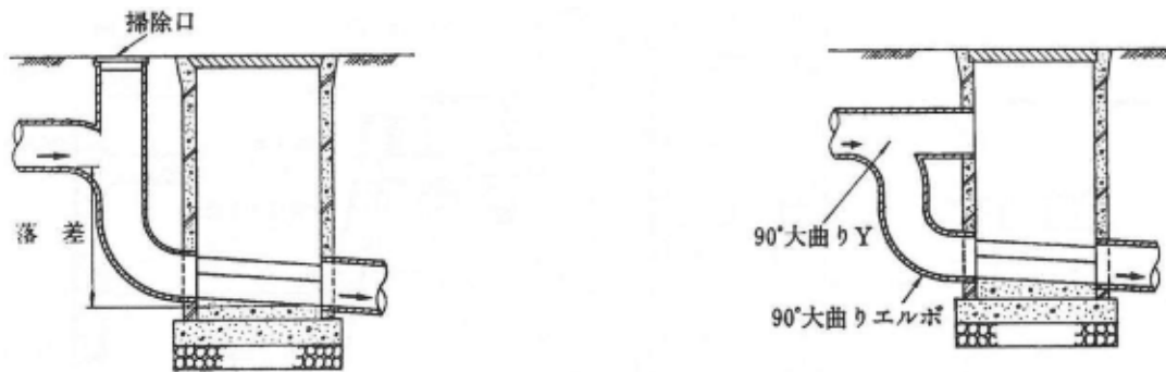
図5-5 ドロップますの例（鉄筋コンクリート製） （下水道排水設備指針と解説 2016年版）
