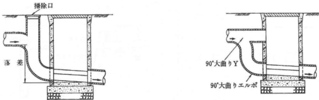
図5-5 ドロップますの例（鉄筋コンクリート製）
