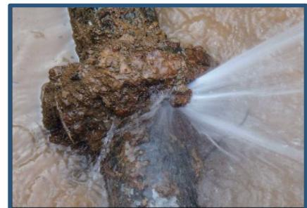
水道管の老朽化に伴う漏水
