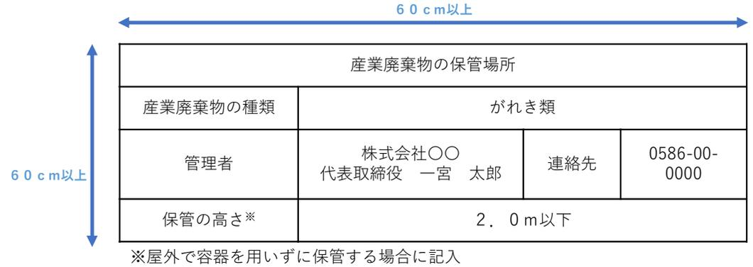
図2 積上げ高さの上限 (屋外で容器を用いずに保管する場合)
