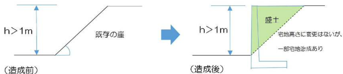
図1-7許可を要する工事(例1)
