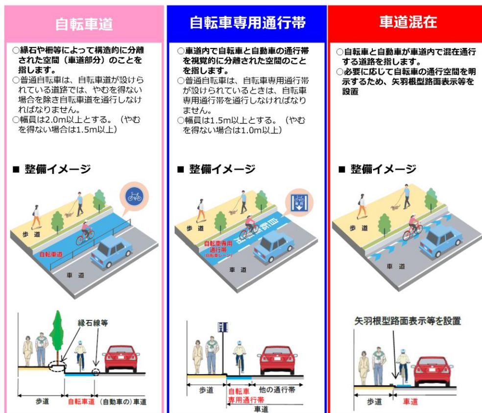
図 6-9 自転車通行空間の整備形態イメージ
