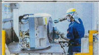
①洗濯機は横向きで解体
